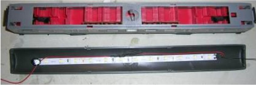
Um die beiden Kabel (0,1 bis 0,14 mm<sup>2</sup>) nach unten zu den Drehgestellen zu bringen können oft vorhandene Öffnungen im Boden genutzt werden, manchmal ist es aber notwendig kleine Löcher zu bohren.
