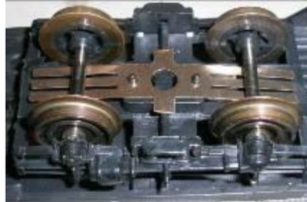
Diese Stromabnehmer passen auf viele Drehgestelle, dafür sind diese mit Kunststoffzapfen versehen. In diesem Fall werden die Stromabnehmer aufgesteckt und dann die Radachsen wieder angebracht. Der Widerstand darf nicht zu stark sein, die Räder müssen sich noch leicht drehen.
